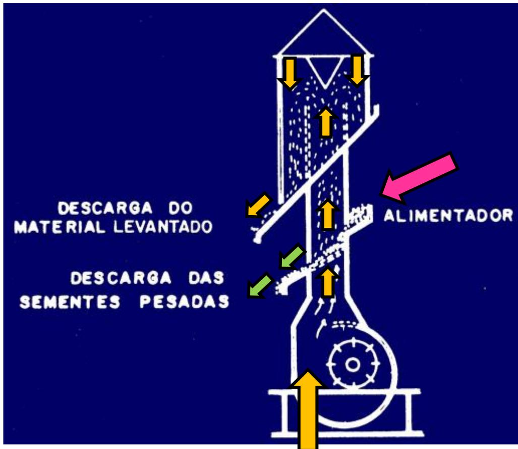
Constituído por uma estrutura metálica semelhante a uma coluna, contendo na extremidade inferior um sistema de ventilação que permite a regulação da corrente de ar
