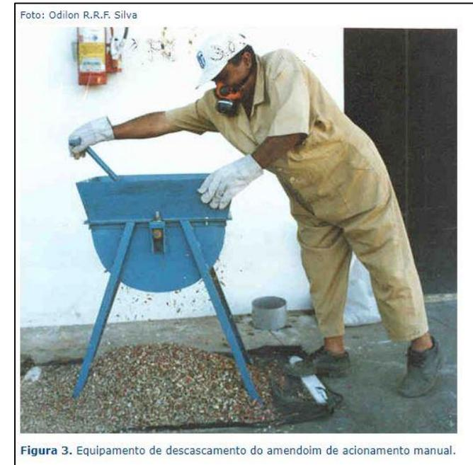
**Figura 3.** Equipamento de descascamento do amendoim de acionamento manual.
