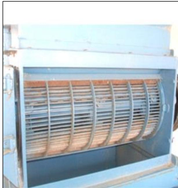
**Mecanismo de descascamento do equipamento constituído por cilindro e côncavo**
