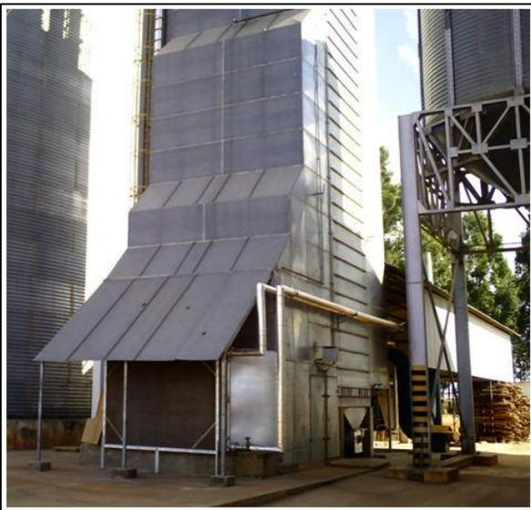
Caldeira acoplada ao secador para aquecimento do ar de secagem
