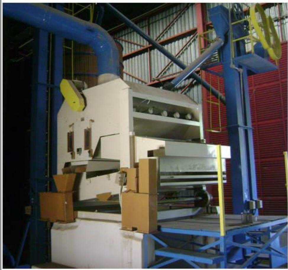
Máquina de ar e peneira utilizada para limpeza de grãos a granel
